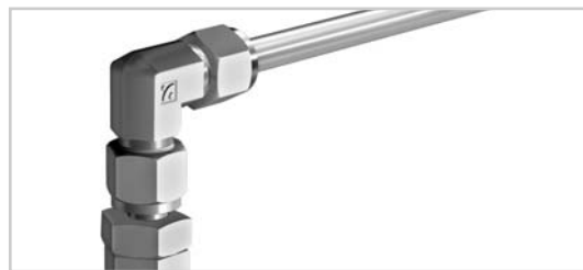
4. スーパーロック・ユニオン・エルボーまたはティーを取り付ける方向に向けた後、スーパーロックチューブ継手をスパナで締め付け、アダプターに接続します。次に、スーパーロックエルボーまたはティーのもう一方のポートにチューブを差し込み、継手を取り付けます。
